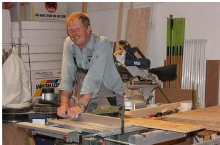
Im Experimentalraum werden die Seitenelemente aus Holz gefertigt.
